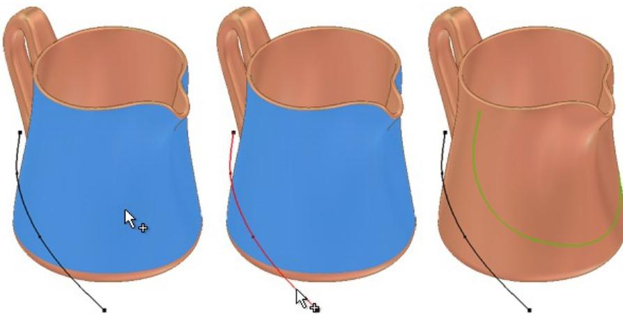
Dans une esquisse 3D, vous pouvez également projeter des points, des courbes, des arêtes ou des faces sur une surface ou un solide. La géométrie projetée est associée à la géométrie parent et à la face projetée. Utilisez la fonction Projeter sur une surface pour envelopper une géométrie dans une face 3D.
