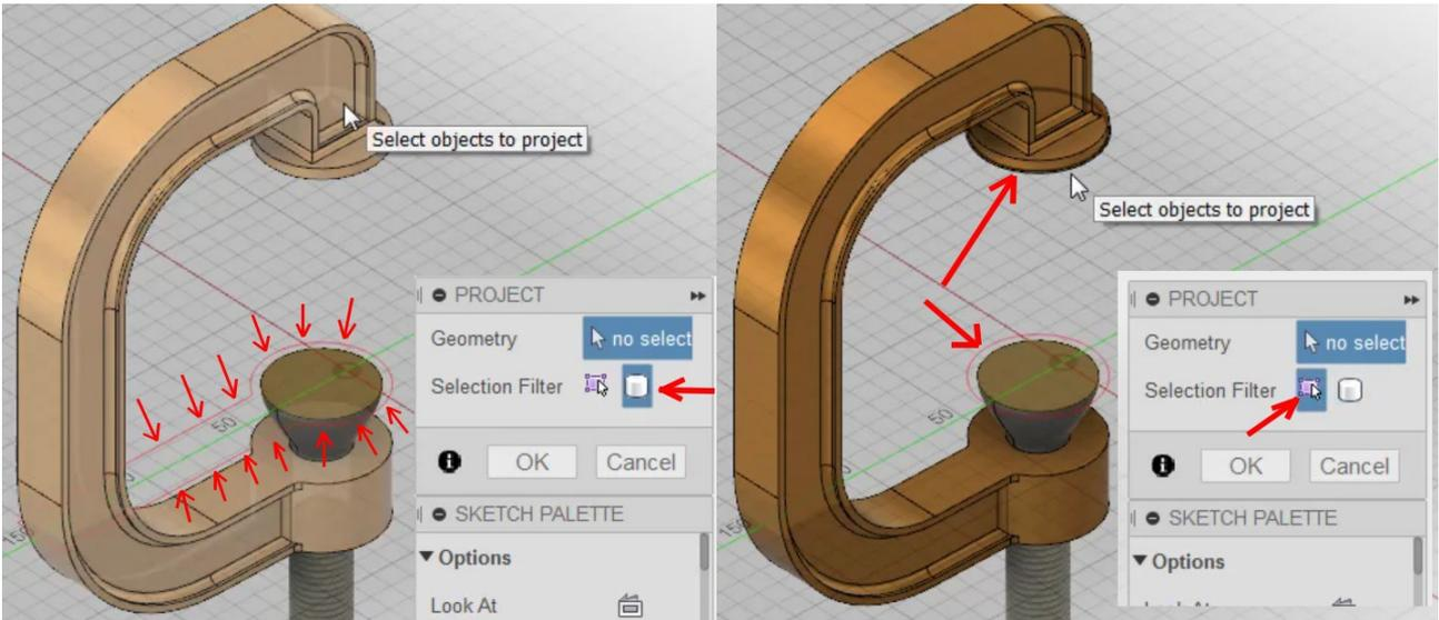
Lorsque vous une faites « **Project** » ou « **Intersect** » le filtre de sélection est sélectionné par défaut sur « **Body** » , l'ensemble des contours vont être projetés.
