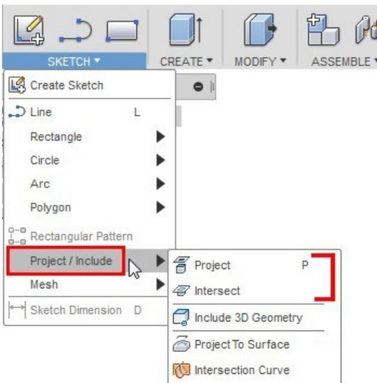
Pour « **Project** » ce sont les contours de la surface de la roue qui vont être projetés sur une esquisse préalablement créée.
