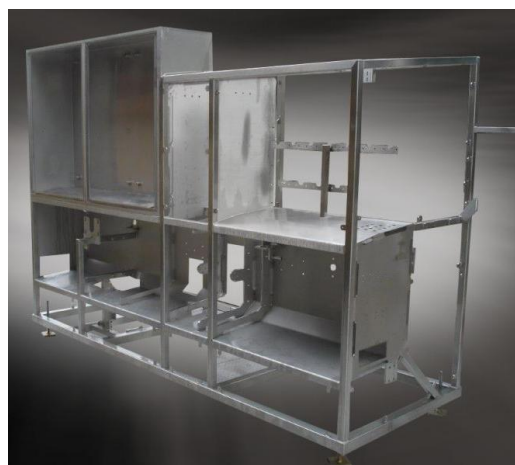
Figure 2 : Châssis mécano-soudé de trancheur agro-alimentaire, image [2]
