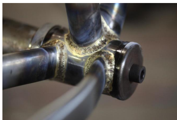
Figure 4 : Soudo-brasure de la douille de direction et détails des soudo-brasures du pédalier sur un cadre de VTT, images [3]
