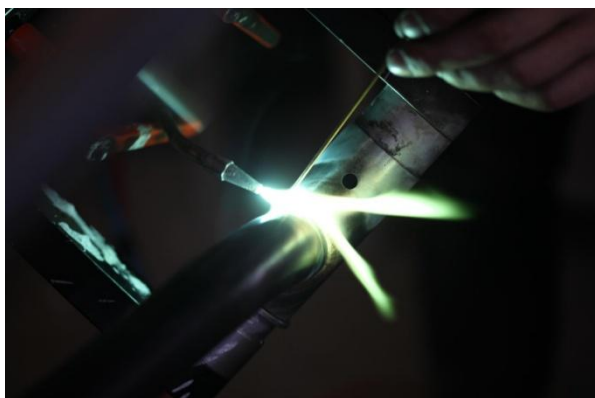
Figure 4 : Soudo-brasure de la douille de direction et détails des soudo-brasures du pédalier sur un cadre de VTT, images [3]
