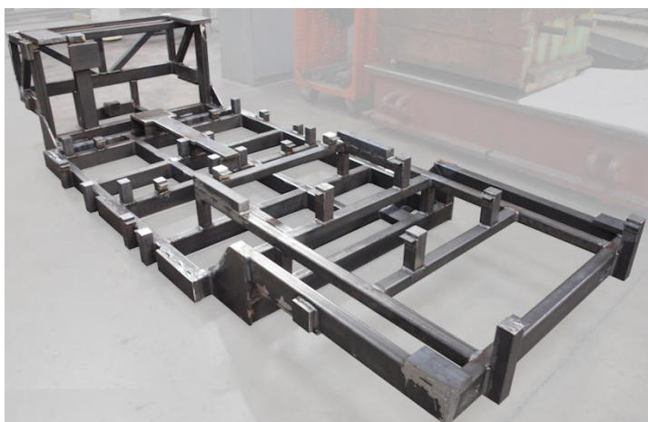
Figure 1 : Bâti mécano-soudé pour concept car, image [1]
